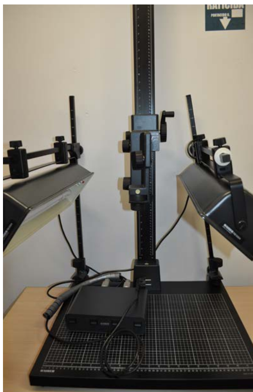
Fig. 1. Mesa de reproducción Kaiser del sistema antiguo que aprovechamos para montar la cámara nueva.
