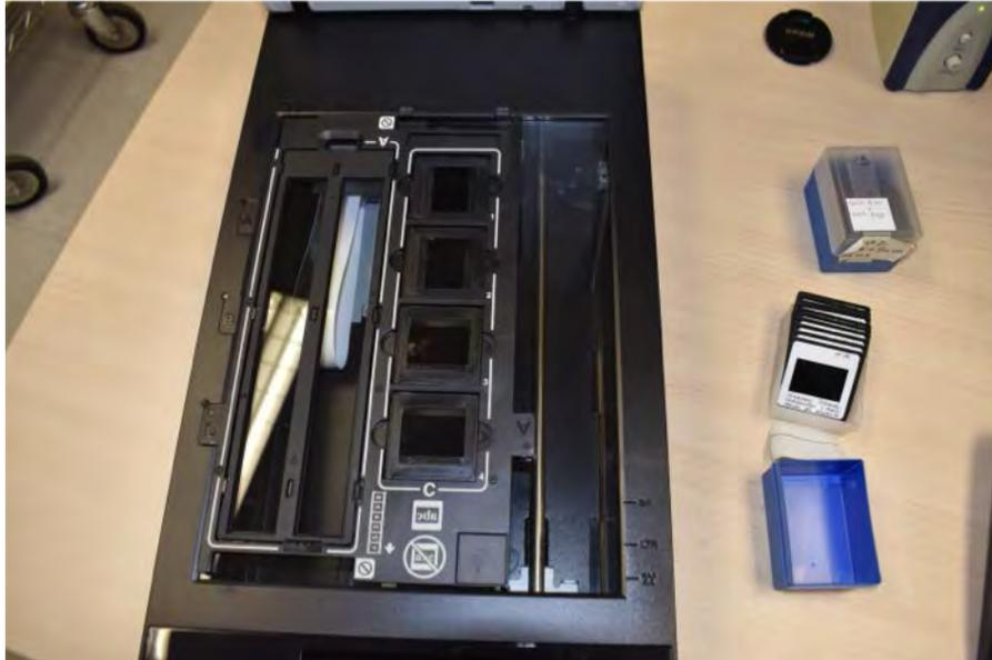
Fig. 6. Escáner con soporte de diapositivas
